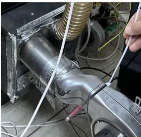
Figura 1.5 – Teste pentru identificarea poziției optime pentru fotorezistență
