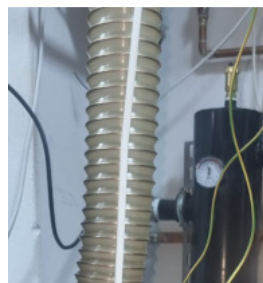
Figura 1.3 – Tub riflă flexibil împotriva arderii inverse
